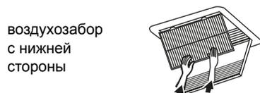
Выровняйте два подвесных кронштейна и вставьте защелки на место (потяните ткань при необходимости). Убедитесь в том, что четыре кронштейна зафиксированы.
