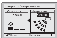
Настройка направления воздушного потока (вверх/вниз)
