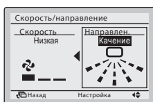
Настройка направления воздушного потока (влево/вправо)
